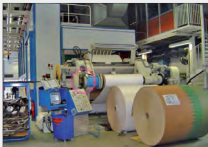
Automatischer Spleißdrehkopf einer Verpackungsmaschine Automatic splice turret on packaging machine
