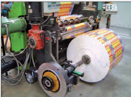
Zugkraftsteuerung der Abrollvorrichtung einer SPAG-Maschine Product tension control on a SPAG machine
